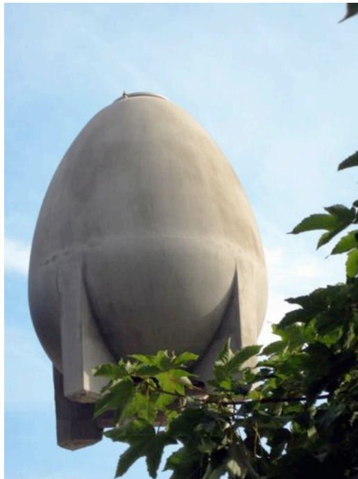
Des cuves en ciment d'argile qui permet une meilleure micro-oxygénation.
